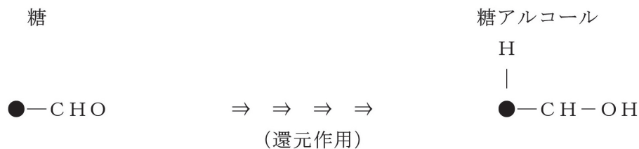
図5 糖アルコールの構造と生成過程
